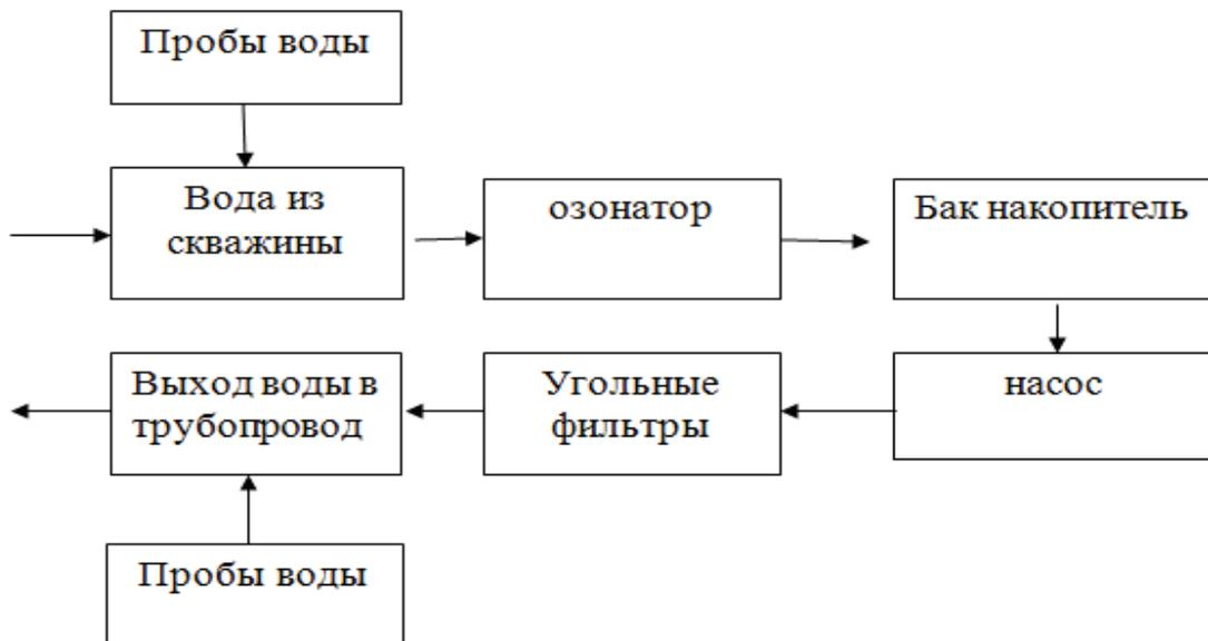
**Рис. 3.** Схема размещения озонатора и угольных фильтров
