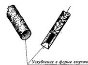
9. Возьмите новый электрод ВСЦ-4 диаметром 3 мм и закрепите его и зажмите электрододержателя.
