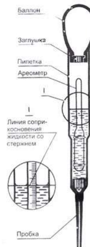
Рис. 7. Схема собранного устройства для отбора тосола
