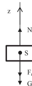
Рис. 76. Расчетная схема для тела, движущегося с ускорением
