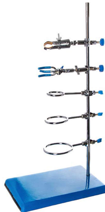
Рис. 24. Лабораторный штатив с набором колец и лапок для установки лабораторной посуды и принадлежностей
