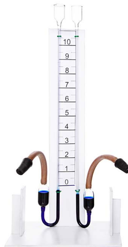
Рис. 34. Прибор для изучения скорости химической реакции
