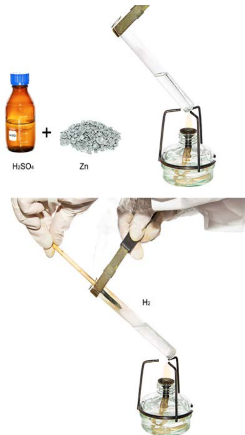
Рис. 89. Взаимодействие цинка с раствором серной кислоты Zn + H_2SO_4 = ZnSO_4 + H_2 \uparrow
