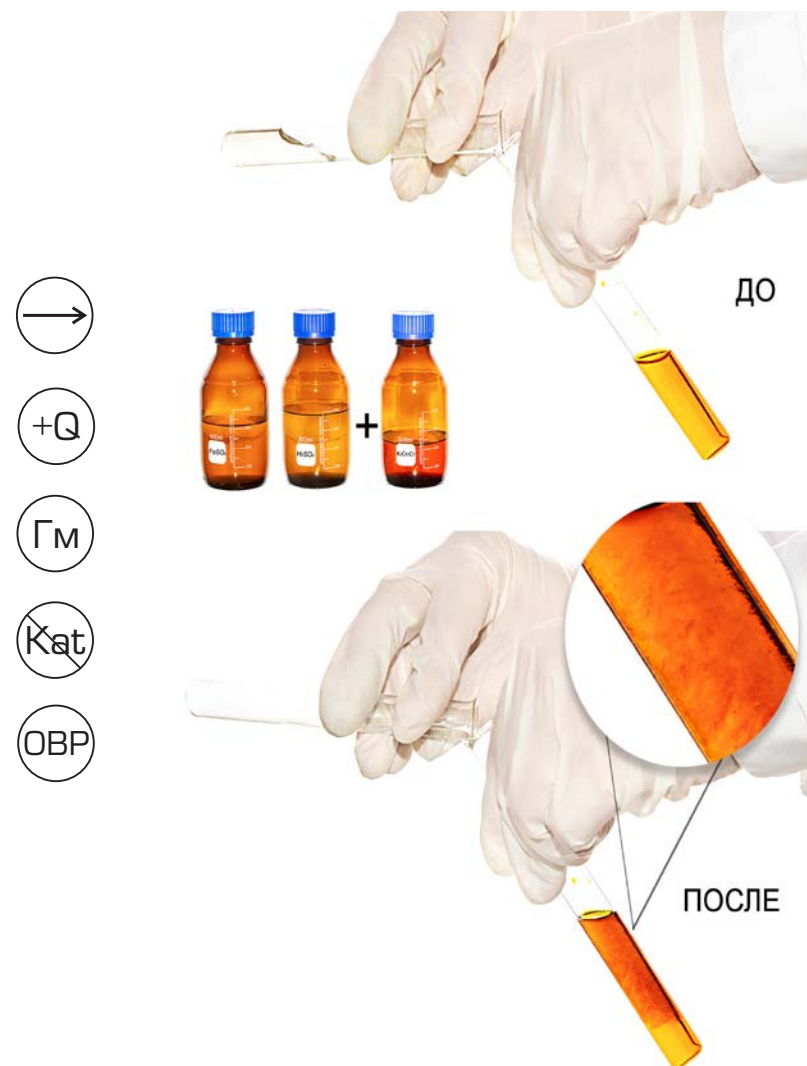
Рис. 119. Восстановление дихромата калия в кислой среде K_2Cr_2O_7 + 6FeSO_4 + 7H_2SO_4 = Cr_2(SO_4)_3 + 3Fe_2(SO_4)_3 + K_2SO_4 + 7H_2O
