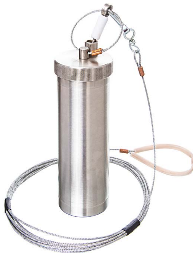
Рис. 38. Пробоотборник для отбора проб нефтепродуктов и специальных жидкостей
