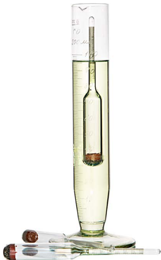
Рис. 79. Измерение плотности ареометром
