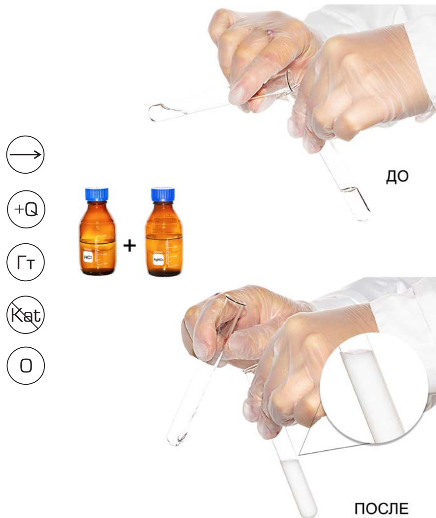
Рис. 99. Образование белого творожистого осадка хлорида серебра \text{AgNO}_3 + \text{HCl} = \text{AgCl} \downarrow + \text{HNO}_3
