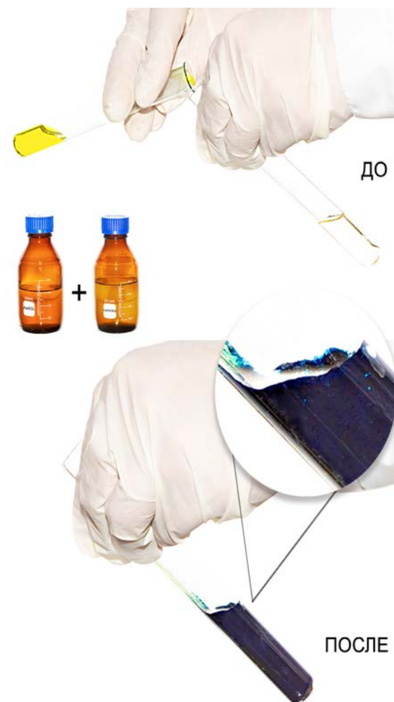
Рис. 121. Качественная реакция на ион железа (II) – при взаимодействии сульфата железа (II) и красной кровяной соли K_3[Fe(CN)_6] образуется темно-синий осадок комплексной соли железа KFe[Fe(CN)_6] – турнбулева синь 2K_3[Fe(CN)_6] + 3FeSO_4 = KFe[Fe(CN)_6] \downarrow + 3K_2SO_4
