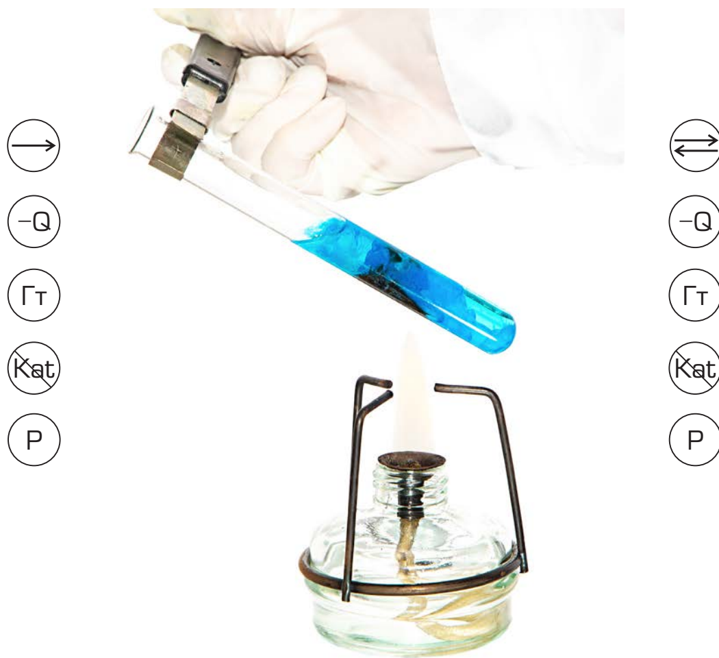
Рис. 90. Разложение гидроксида меди \text{Cu}(\text{OH})_2 = \text{CuO} + \text{H}_2\text{O}
