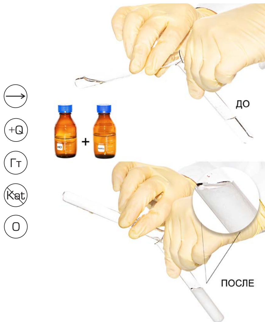
Рис. 97. Образование осадка гидроксида свинца белого цвета \text{Pb}(\text{NO}_3)_2 + 2\text{NaOH} = \text{Pb}(\text{OH})_2 \downarrow + 2\text{NaNO}_3
