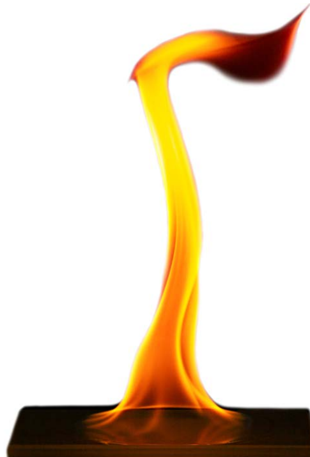
Рис. 82. Горение дизельного топлива копящим пламенем
