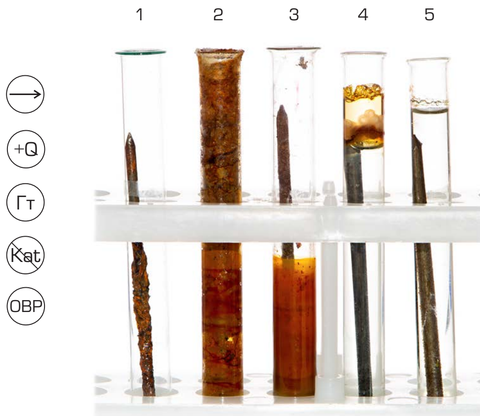
Рис. 110. Результаты эксперимента по коррозии железного изделия: в пресной воде (1), в морской воде (2), в разбавленном растворе кислоты (3), в пресной воде с изоляционным слоем масла (4), в масле (5)
