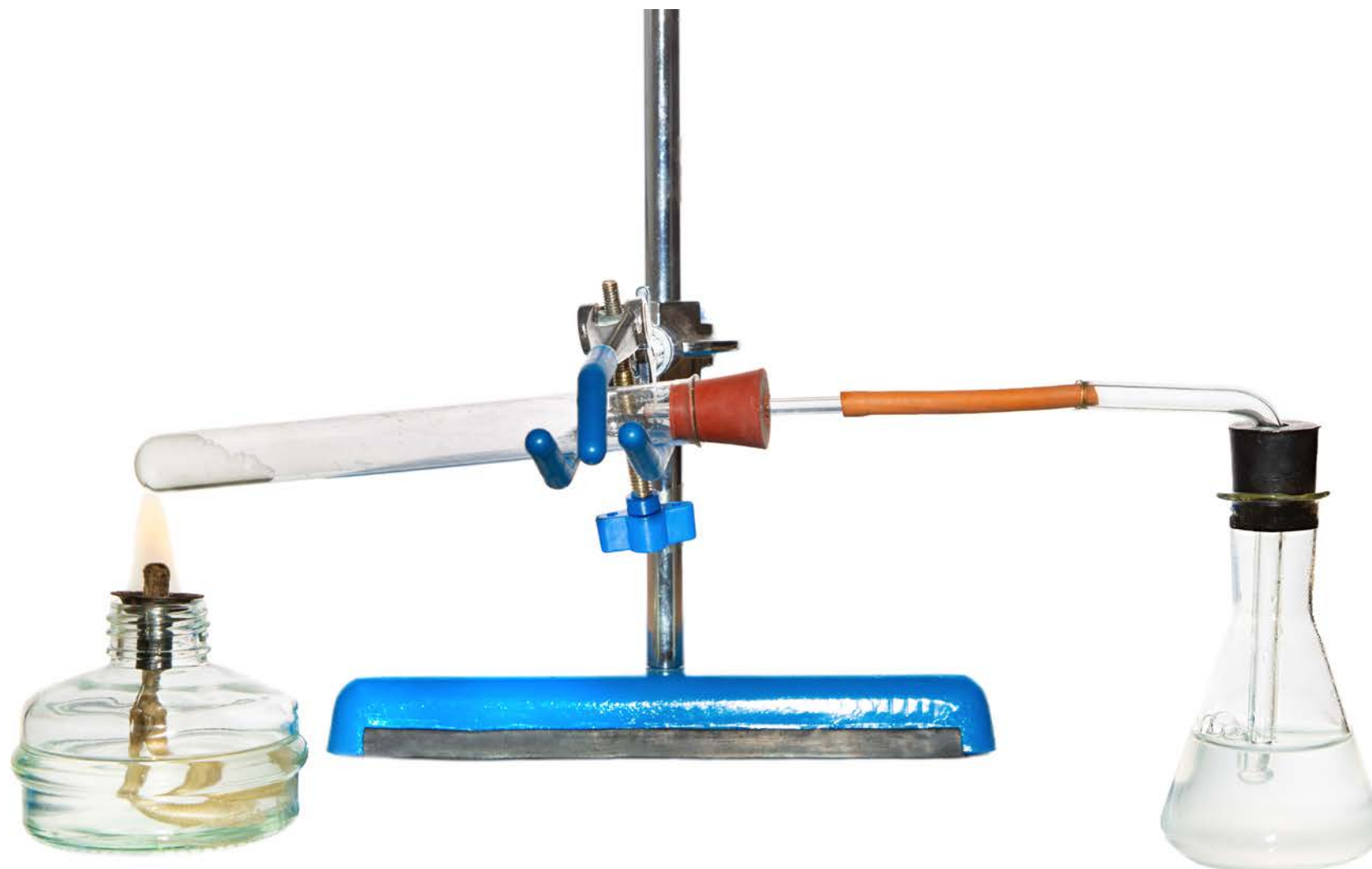
Рис. 92. Разложение карбоната калия \text{K}_2\text{CO}_3 = \text{K}_2\text{O} + \text{CO}_2 \uparrow
