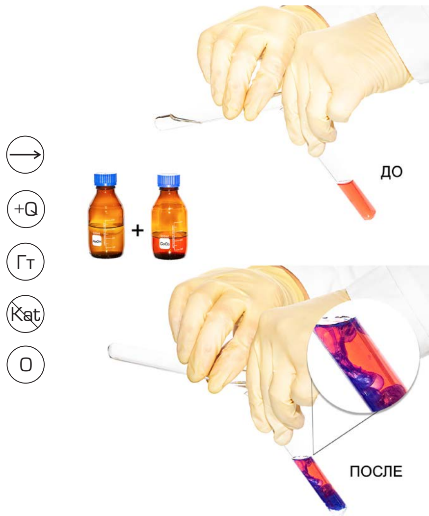
Рис. 95. Образование осадка гидроксида кобальта розово-фиолетового цвета \text{CoCl}_2 + 2\text{NaOH} = \text{Co(OH)}_2 \downarrow + 2\text{NaCl}
