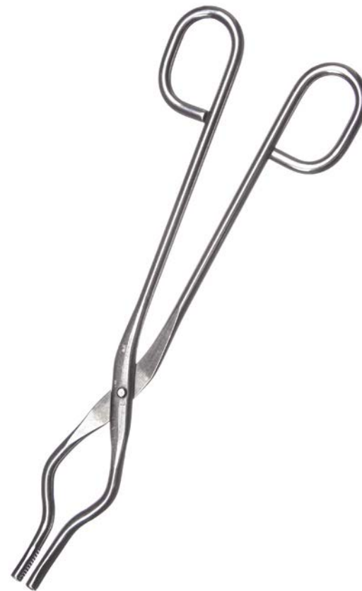
Рис. 20. Щипцы тигельные для захвата и переноса тиглей, стаканов и другой посуды, которая используется в лабораториях и подлежит нагреванию на водяных банях, спиртовках, а также в муфельных и тигельных печах
