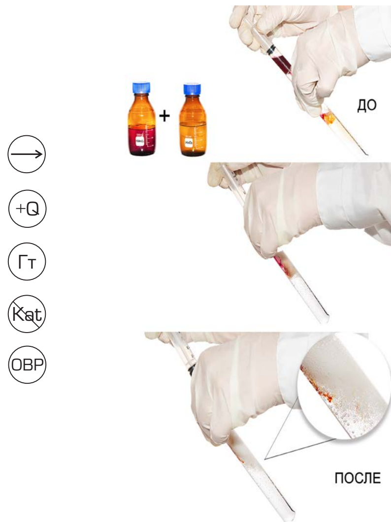
Рис. 113. Восстановление перманганата калия до оксида марганца (IV) 4\text{KMnO}_4 + 4\text{H}_2\text{O}_2 = 4\text{MnO}_2 \downarrow + 2\text{H}_2\text{O} + 4\text{KOH} + 5\text{O}_2 \uparrow
