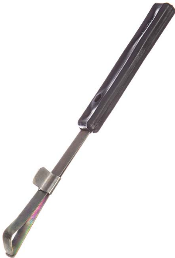
Рис. 19. Зажим пробирочный для удержания (фиксации) пробирок
