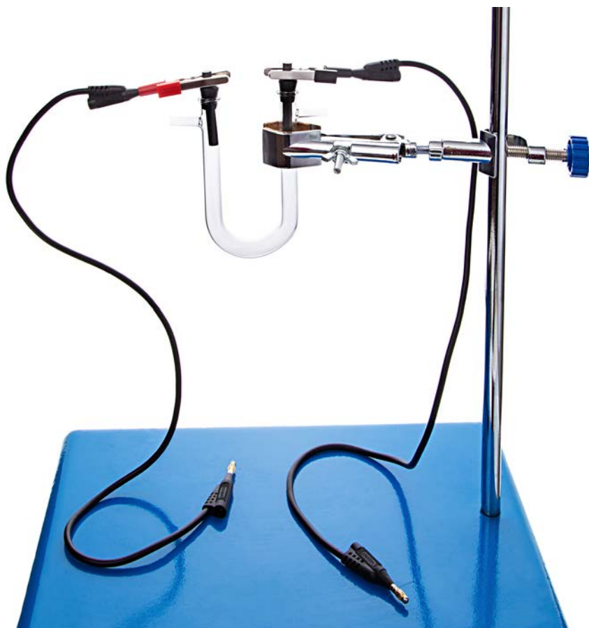
Рис. 33. Прибор для изучения электролиза растворов электролитов
