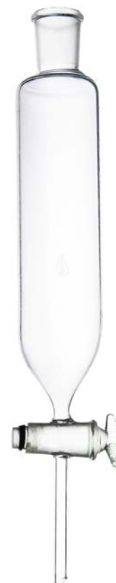
Рис. 10. Воронка делительная для разделения несмешивающихся нелетучих жидкостей в процедурах экстрагирования
