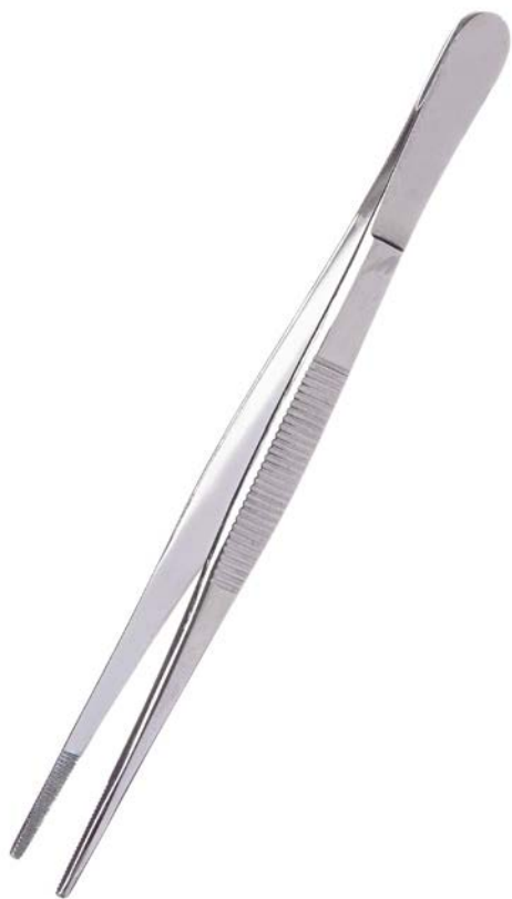
Рис. 17. Пинцет для захватывания мелких предметов, а также веществ, которые нельзя брать руками, например, металлический натрий
