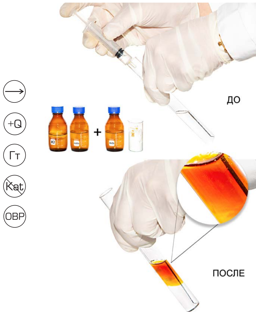
Рис. 112. Окисление иодида калия до йода в кислой среде 2\text{KI} + \text{H}_2\text{O}_2 + \text{H}_2\text{SO}_4 = \text{I}_2 \downarrow + \text{K}_2\text{SO}_4 + 2\text{H}_2\text{O}
