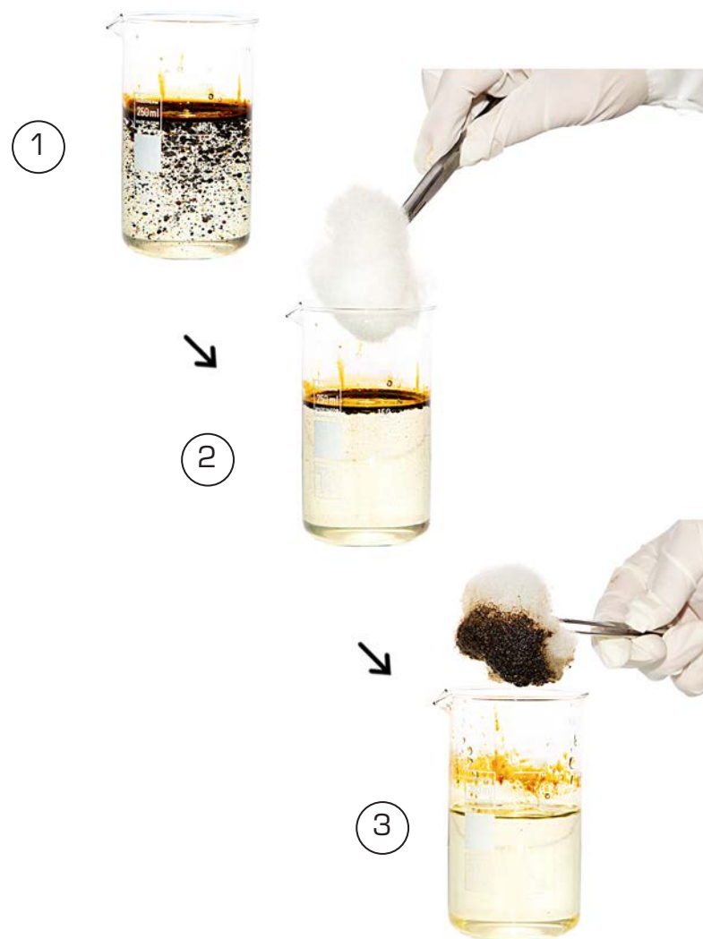
Рис. 87. Этапы нефтесорбции: 1 – имитация аварийного разлива нефти, 2 – использование сорбента, 3 – извлечение нефти с помощью сорбента
