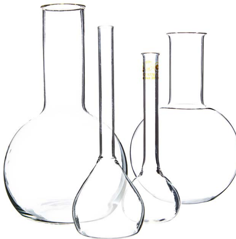
Рис. 6. Колбы для отмеривания жидкости в заданном объеме, фильтрования в лабораторных условиях
