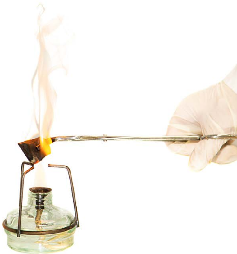
Рис. 88. Горение угля C + O_2 = CO_2 \uparrow
