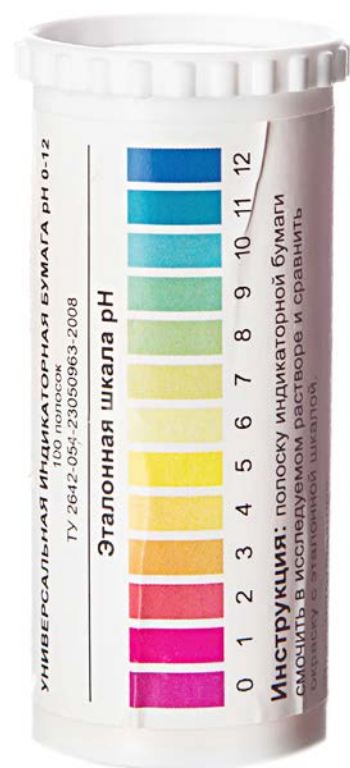
Рис. 27. Индикаторная бумага универсальная для определения реакции среды (нейтральная, кислая или щелочная)
