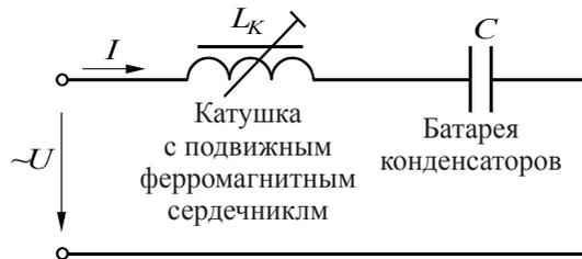
**Рис. 4** – Цепь с последовательным соединением конденсатора и катушки
