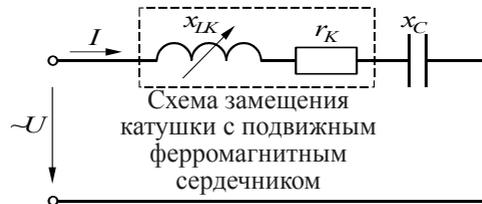
**Рис. 5** – Схема замещения
