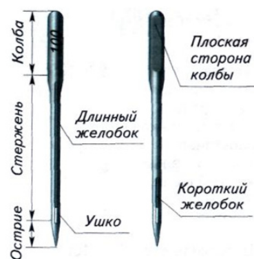
Рис. 19. Устройство машинной иглы
