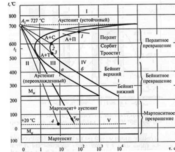
Рис. 25. Диаграмма изотермического превращения переохлаждения аустенита стали У8 (0,8 % С)
