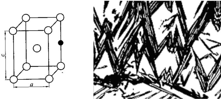
Рис. 28. Кристаллическая решетка и микроструктура мартенсита,  $\times 500$
