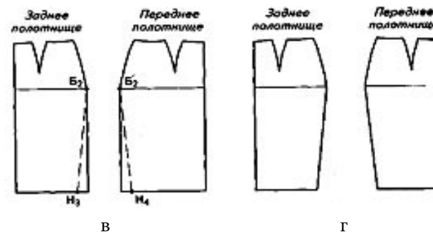
Рис. 52. Заужение полотнищ юбки по линии низа
