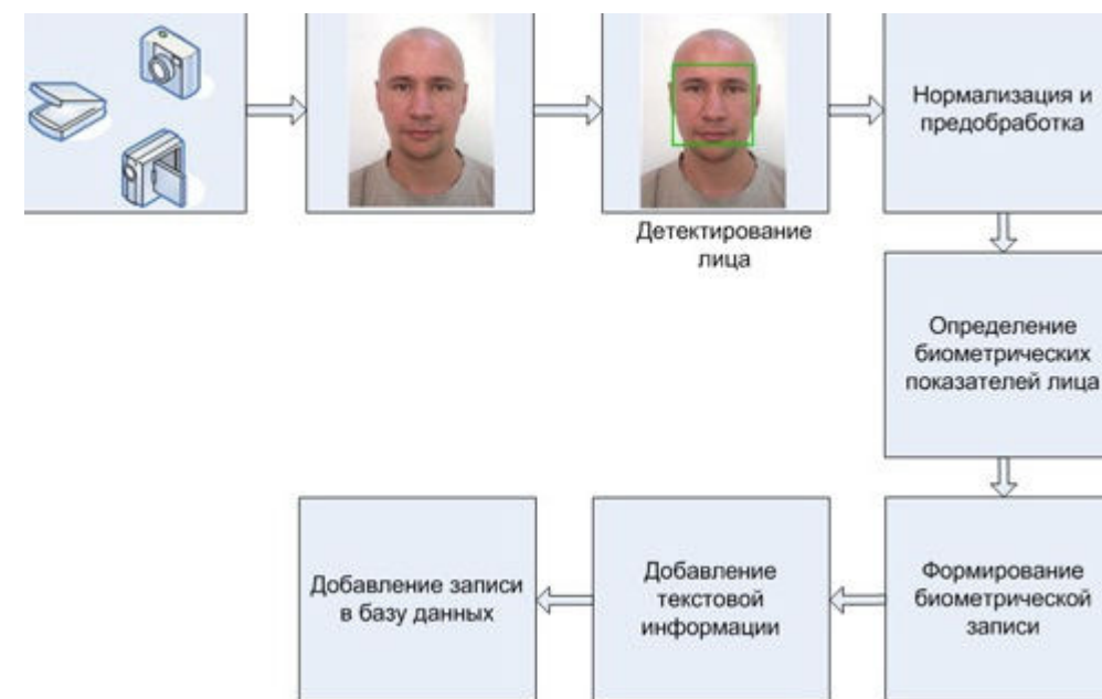
Рис. 31. Формирование биометрической записи для сохранения или поиска в базе данных
