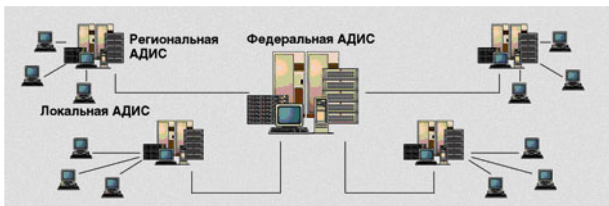
Рис. 29. Схема архитектуры АДИС
