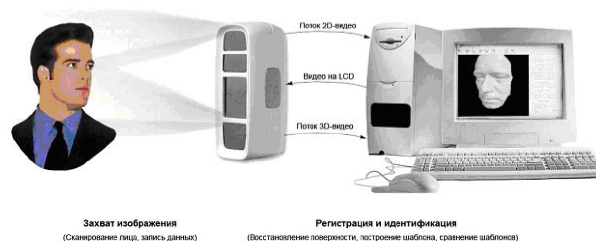
Рис. 27. Принцип технологии трехмерного распознавания
