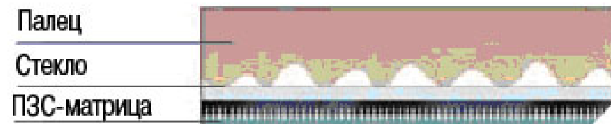
Рис. 20. Схема принципа устройства оптического сканера
