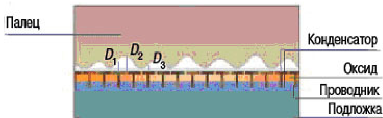
Рис. 17. Схема принципа устройства «конденсаторного» (кремниевого) сканера
