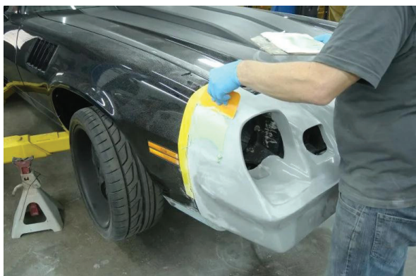
Рис. 3. Формовка деталей из стеклопластика на основе эпоксидной смолы
