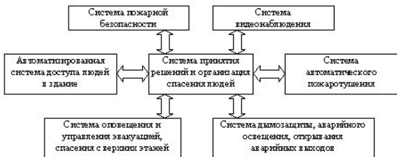
Рис. 3. Вариант построения комплексной системы безопасности в здании
