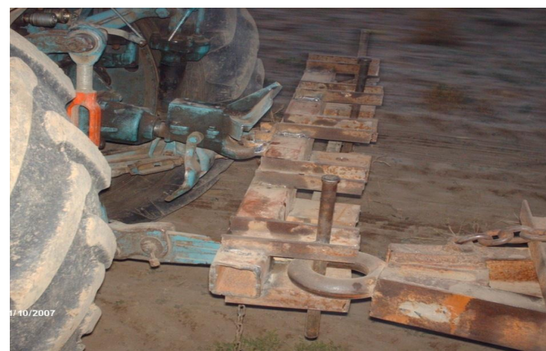
Рис. 3.5. Перемещение точки прицепа в левую сторону на расстояние 0,60 м
