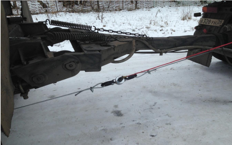
Рис. 3.30. Измерение тягового усилия на ТТДУ
