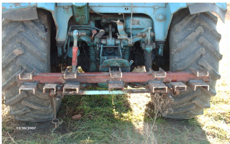
Рис. 3.3. Экспериментальная установка для изменения точки прицепа
