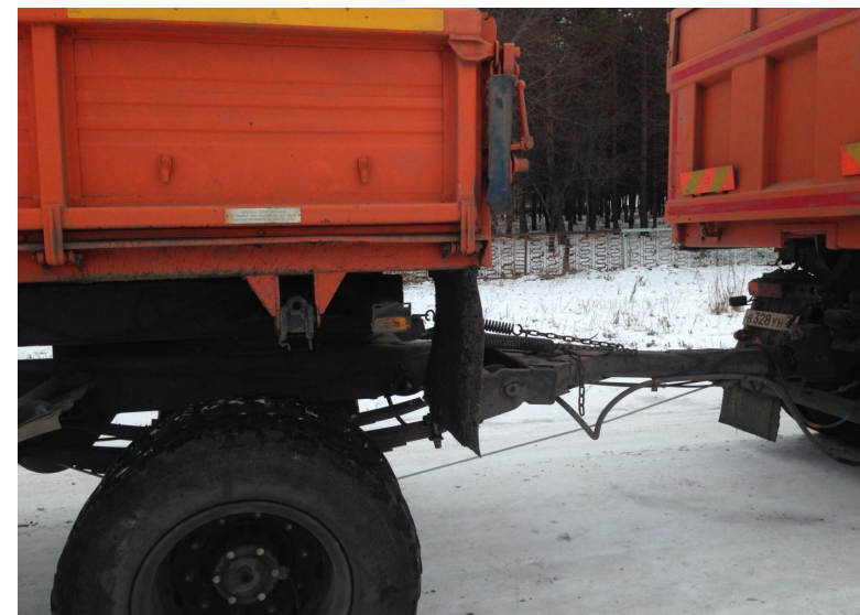
Рис. 3.27. Установленное тросопневматическое тягово-догружающее устройство на прицепе
