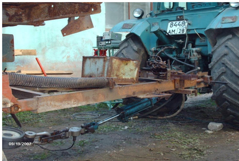
Рис. 3.9. Измерение дополнительного усилия на дышло прицепа
