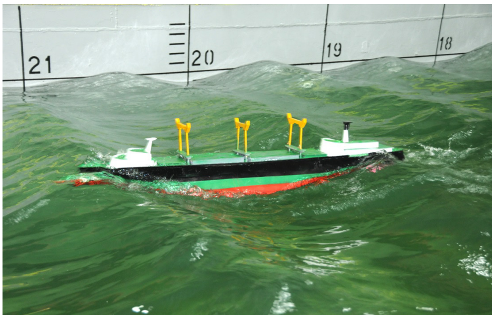
Рис. 5 – Опытный бассейн комсомольского-на-амуре государственного технического университета. поверочные испытания телеуправляемой модели судна, оснащенной блоками телеметрии для экспериментов на морском полигоне сахгу в открытом море
