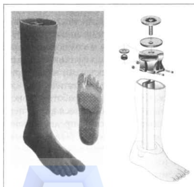
Рис. 271. Протез голени для плавания
