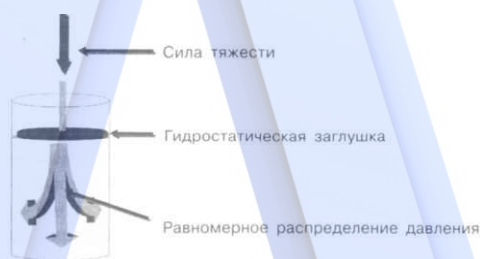
Рис. 152. Схема распределения давления в силиконовом чехле
