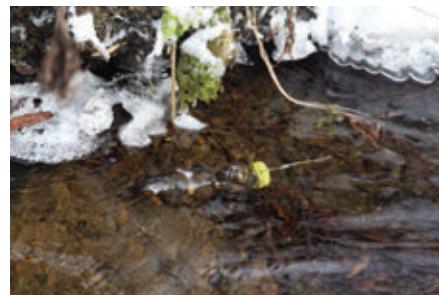
9. Фиксация пластикового контейнера с термодатчиком в реке
