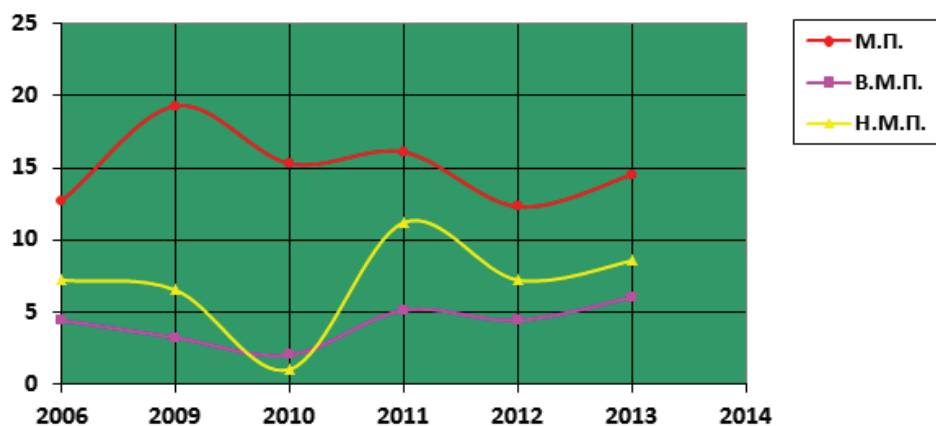
Рис. 3 – Динамика содержания частиц диаметром <1 мм в грунте на различных станциях р. Ай (м. п. – место пересечения нефтегазопровода, участок протяженностью 60 м; в. м. п. – выше места пересечения на 500 м от верхнего края пересечения, н. м. п. – ниже места пересечения на 500 м от нижнего края пересечения)
