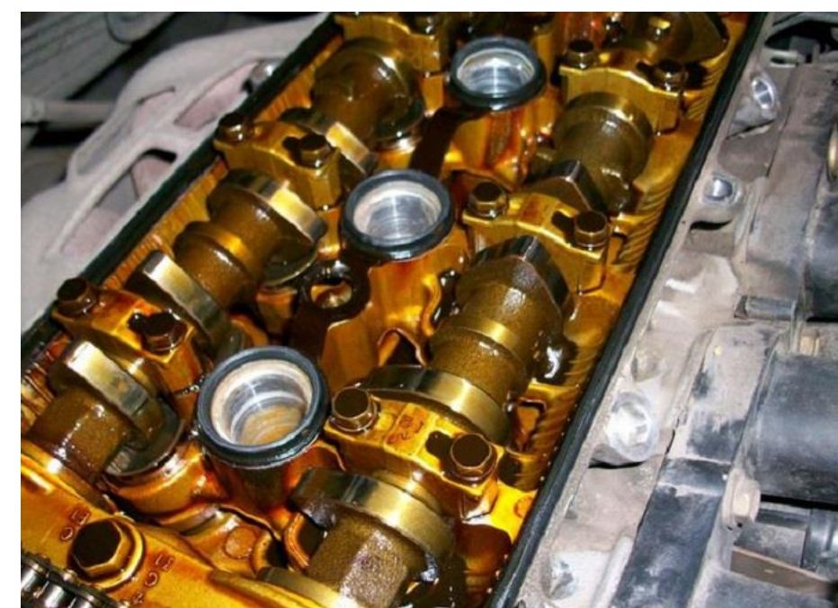
Рис. 1. Лакообразование на поверхности деталей ДВС в результате несвоевременной замены моторного масла
