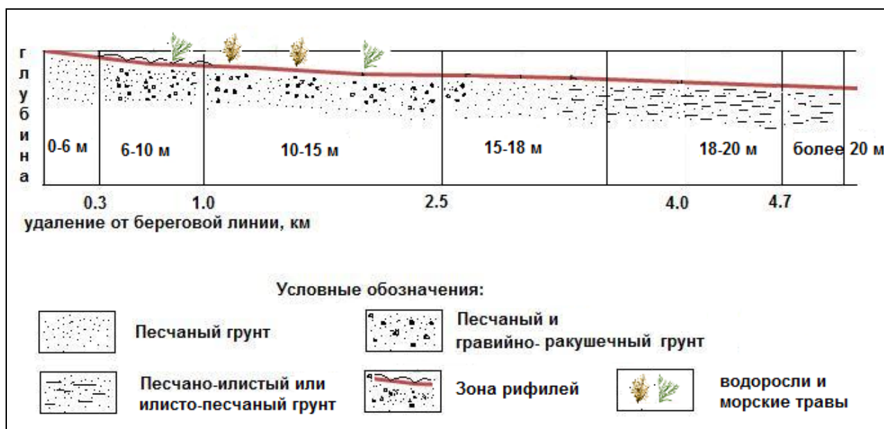
Рисунок 2.2. Схематичный профиль прибрежной зоны центральной части залива Анива, выбранного для проведения экспериментальных исследований
