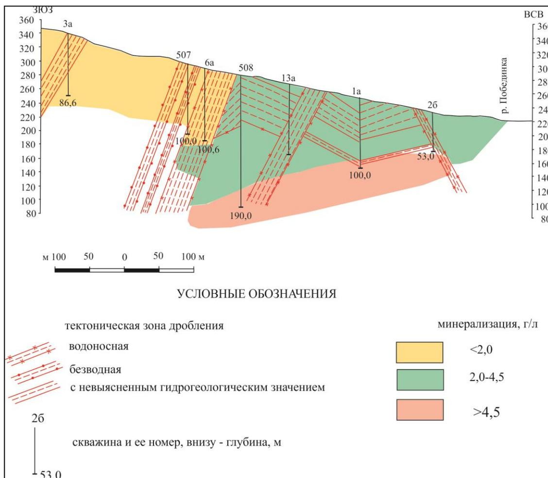
Рис. 4.1.4. Гидрогеохимический разрез месторождения «Топольное» (Завадский И.Г., по материалам Чебан В.Я., 1972)
