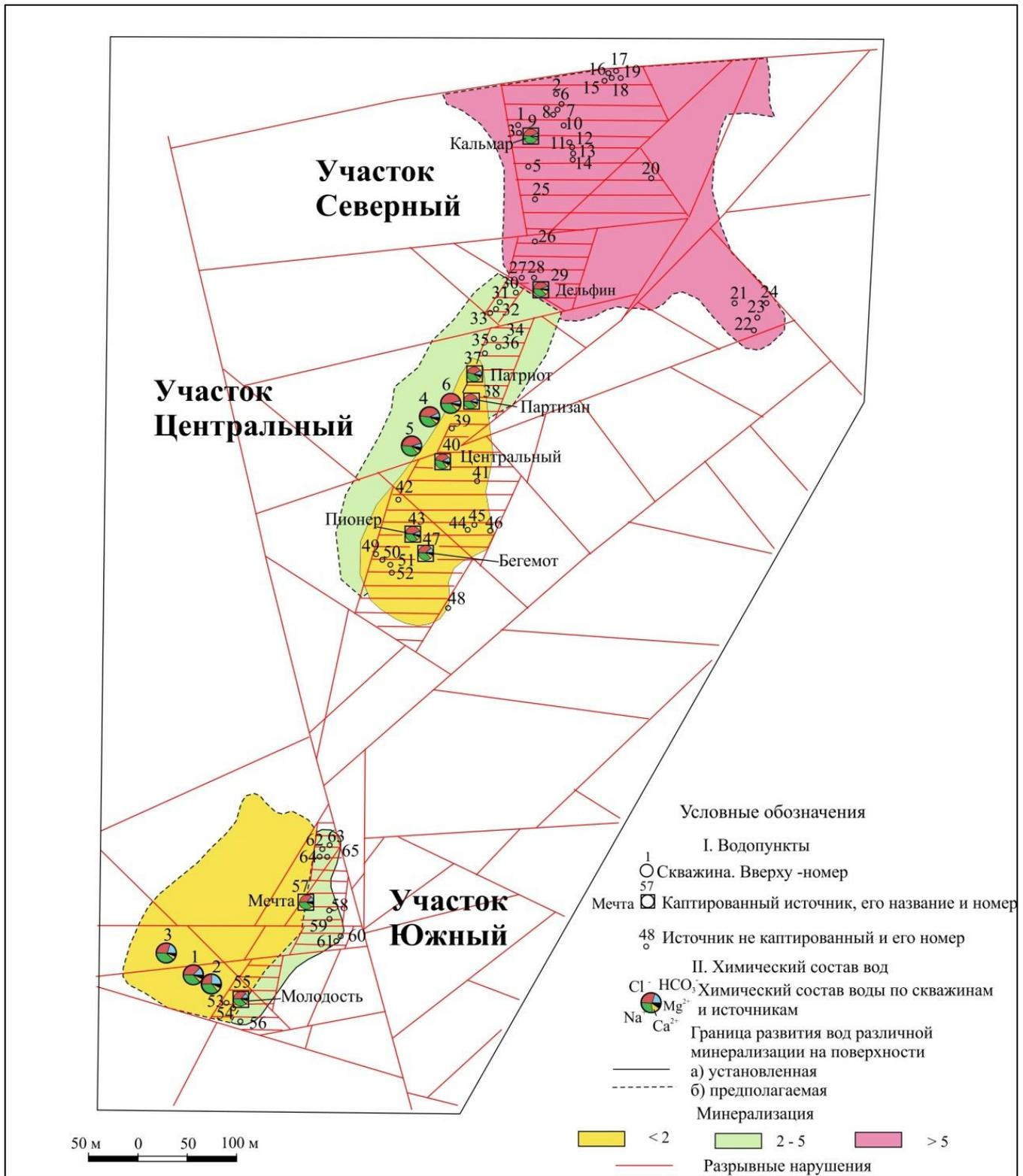
Рис.2.1.4. Схема строения Дагинского месторождения термальных минеральных вод
