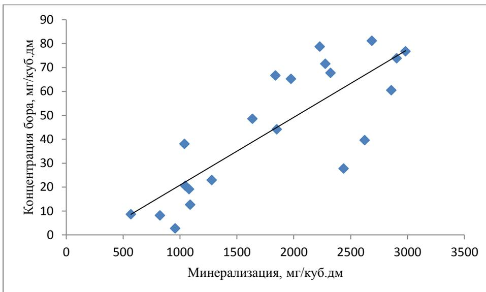
Рис. 13.1.3. График зависимости концентрации бора в воде от минерализации
