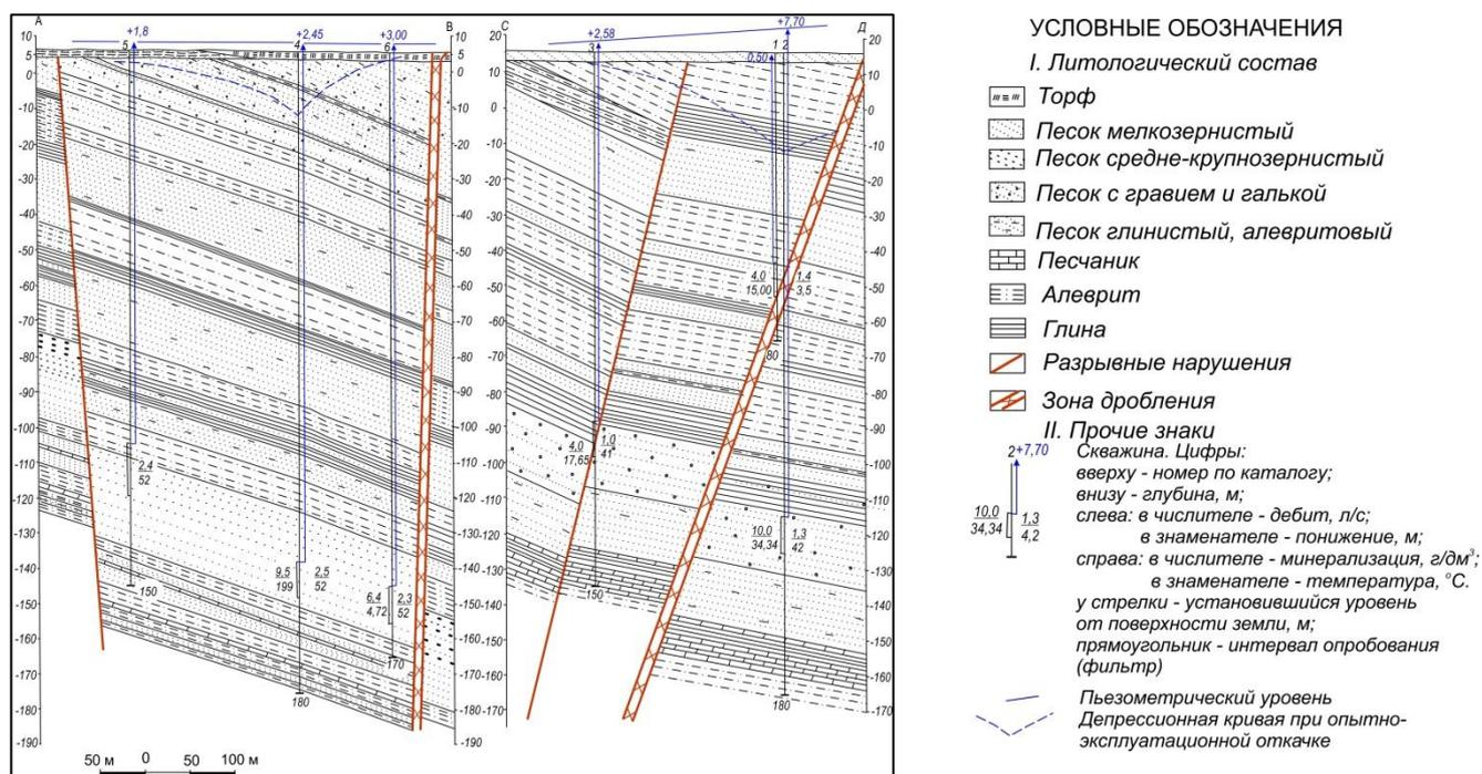
Рис.2.1.3. Геологический разрез Дагинского месторождения термальных минеральных вод
