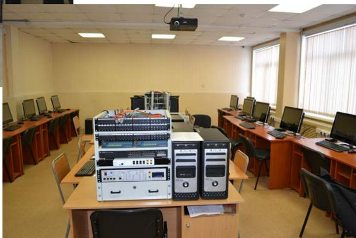
Для моделирования локальных учебных сетей, лаборатория оснащена комплектом цифровых и аналоговых телефонов, коммутаторов, маршрутизаторов и проводами коммутации.
