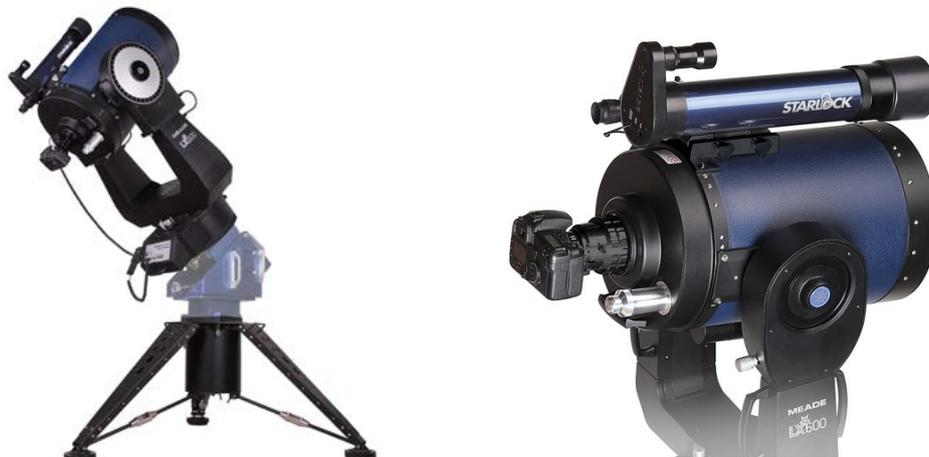
Как только телескоп наведен на интересующий наблюдателя объект, StarLock самостоятельно выбирает звезду для гидирования (до 11 звездной величины) и производит захват. После того, как звезда захвачена, StarLock непрерывно передает данные о её положении двигателям монтировки, которые, в свою очередь, корректируют положение трубы телескопа.
